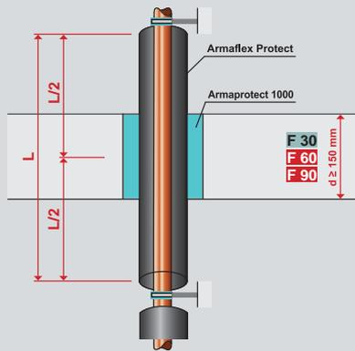
Armaflex Protect kann auch in Deckendurchbrüchen zentriert montiert werden. Der verbleibende Spalt in der Durchführung oder der Kernbohrung wird mit Armaprotect 1000 oder nichtbrennbaren, formbeständigen Baustoffen wie z. B. Beton, Zementmörtel etc. verschlossen.
