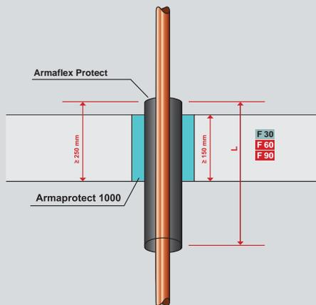
Wenn keine Isolierung über der Decke erforderlich ist oder möglich ist, kann Armaflex Protect auch unter der Decke installiert werden. Auf diesen Weg können beispielsweise Heizkörperanbindungen einfach und sicher verschlossen werden.
